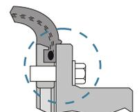
"Para un ajuste preciso utilizar torquímetro, según valores de torque indicados en la tabla. Para el ajuste de cubos integrales o platos bridas sólo utilizar torquímetro."
